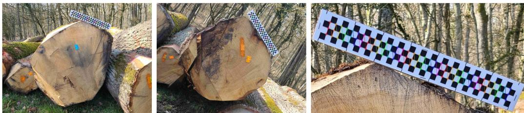
FIGURE 1 – Photos prises à la culée de grumes de chêne. Une mire en damier blanc et noir est placée sur la grume de façon à permettre la calibration spatiale des images. Ici, une fonction d'OpenCV a permis de détecter la mire automatiquement (à droite).
