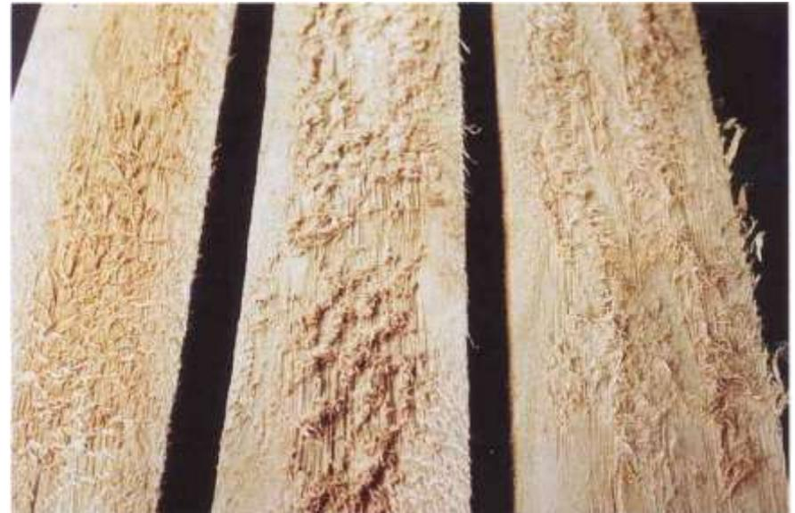
**Photo 1.** Lamelles de peuplier montrant un état de surface pelucheux suite à la présence de fibres gélatineuses en proportion importante dans le bois — *Poplar planks showing woolly surface due to the presence of an important proportion of gelatinous fibers in the wood.*
