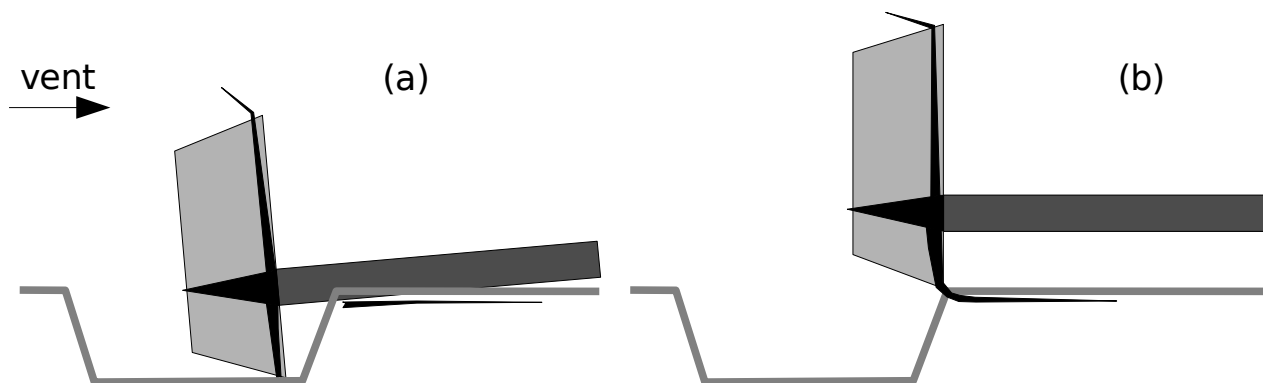
fig 7 : Représentation schématique d'un chablis : (a) les racines traçantes sous le vent en limite de bulbe ont cassé, la plaque sol racine a pivoté dans le sol. (b) les racines traçantes sous le vent ont seulement plié, la plaque racinaire et le tronc sont soulevés (Schéma F. Danjon d'après Stokes, 2002).
