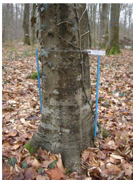
Figure 23 : Jalons intermédiaires permettant d'obtenir une ligne droite entre les deux bornes.
