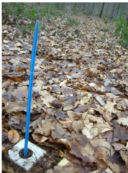
Figure 22 : Matérialisation de l'axe d'une bande floristique à l'aide de topofil.
