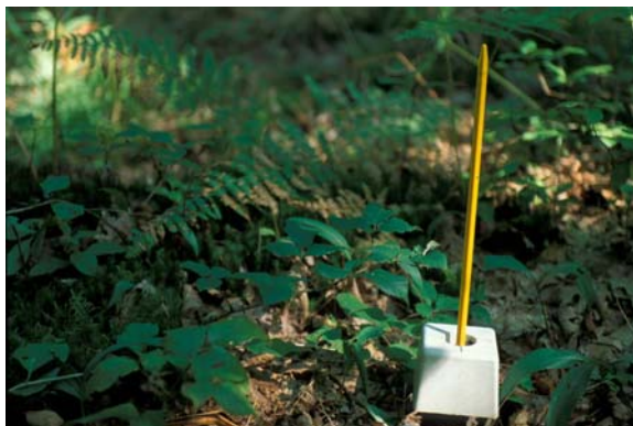
Figure 21 : Borne de géomètre blanche matérialisant le milieu d'un coté d'une bande floristique.
