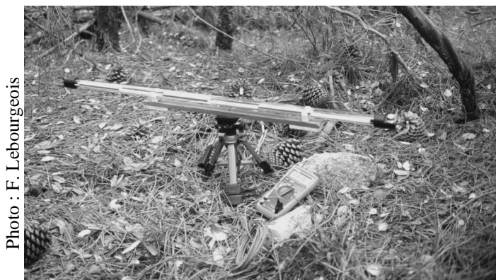
Mesure de rayonnement dans un peuplement de Pin maritime en Forêt de Sorbollano (Corse)
